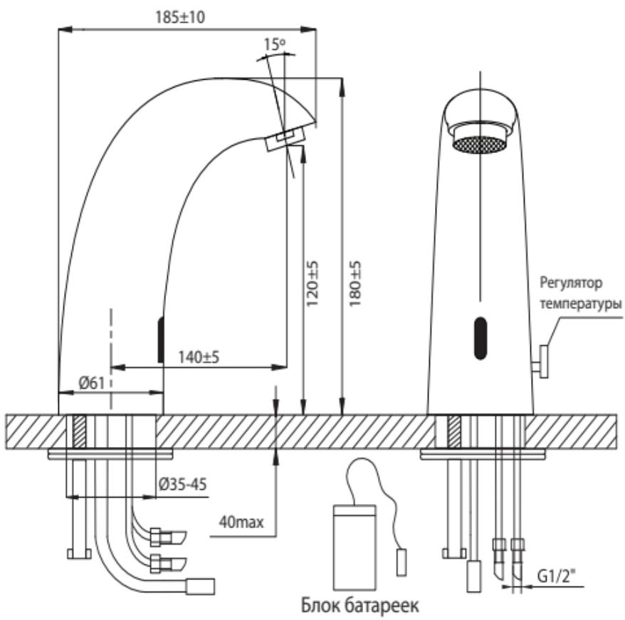
Замену встроенных элементов питания следует производить 1 раз в год. В зависимости от условий эксплуатации и качества используемых элементов питания возможно возникновение необходимости более частой смены элементов питания.
